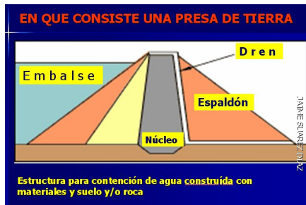
Figura 6.1 Zonificación de una presa de tierra y enrocamiento
