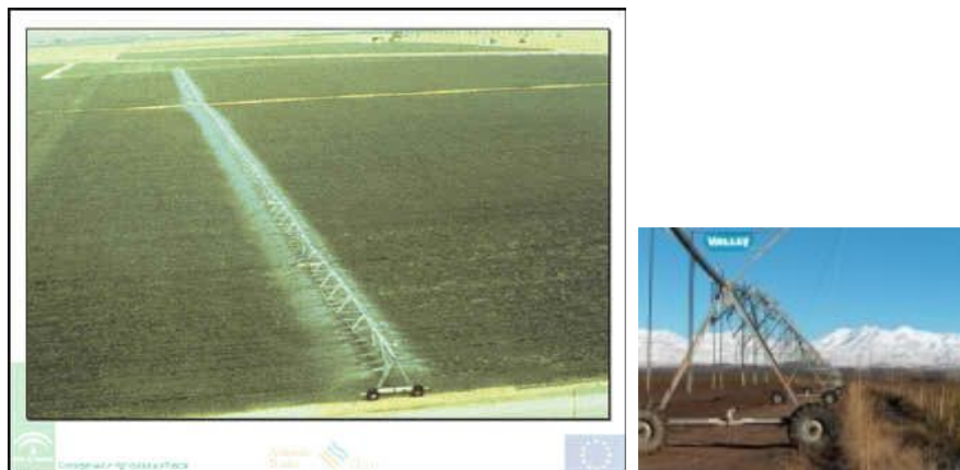
Figura 3.18 Sistema mecanizado de lateral con ruedas
