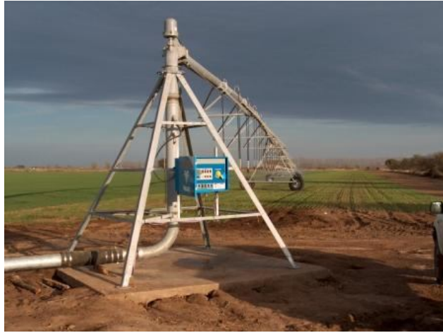
Figura 3.19 Sistema mecanizado de pivote central
