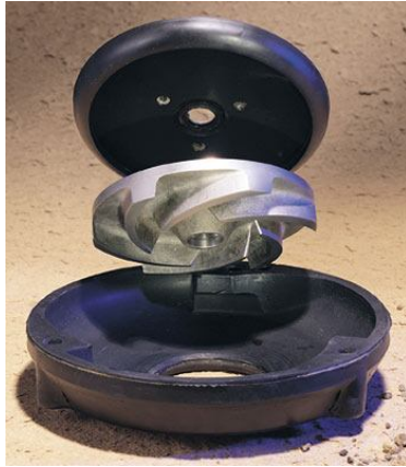
Figura 3.9 Impulsor abierto y diferentes tipos de bombas y cedazos
