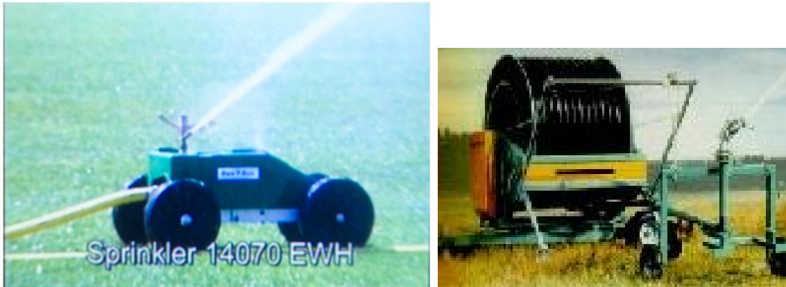
Figura 3.20 Sistema mecanizado con aspersores viajeros y cañón viajero
