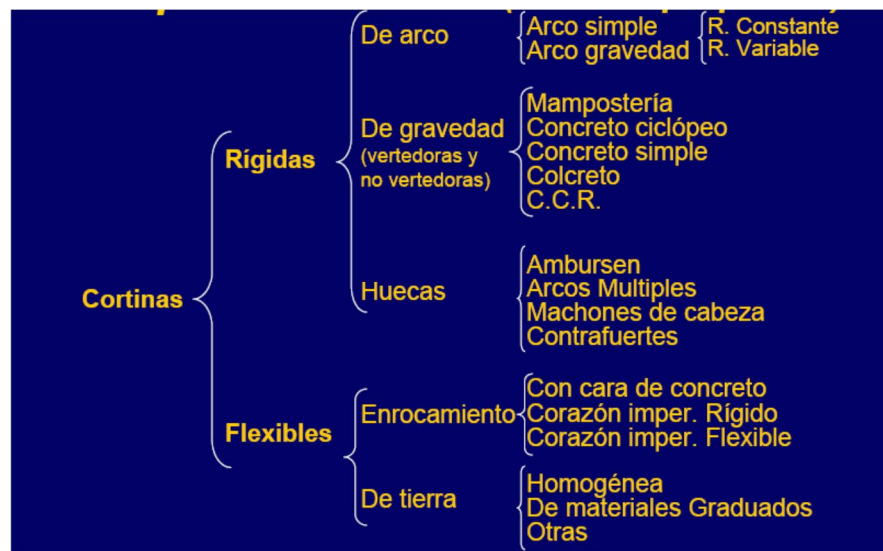
Figura 4.6 Clasificación de tipos de cortinas
